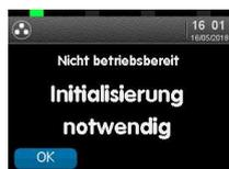
Die Initialisierung wird mit der OK-Taste gestartet. Sofern alle Kommunikationsparameter korrekt gesetzt wurden und die Anschlussverkabelung ggf. hergestellt wurde, beginnt das Terminal mit der Anwahl an den Host ihres Netzbetreibers und führt diverse Diagnosen durch. Sind alle Diagnosen ordnungsgemäß durchlaufen, wechselt die Anzeige des Terminals in den Grundzustand (Abb. rechts) und ist nun betriebsbereit.
