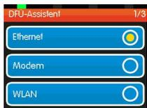
Auswahl der Option „Ethernet“ mit den Pfeiltasten  $\nabla/\blacktriangle$  und mit OK-Taste bestätigen.
