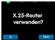
Diese Abfrage ist nur in sehr speziellen Fällen mit „Ja“ zu beantworten. Im Normalfall werden X.25-Router nicht eingesetzt und die Abfrage kann mit „Nein“ () beantwortet werden.
